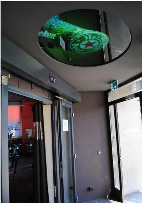
Rückprojektion in der Hohldecke mit 3M Folie und Digital Projektor
