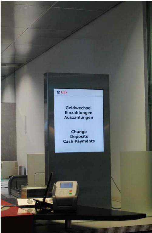
Schalterbeschriftung dynamisch mit 15" Display & Umschalttastatur
